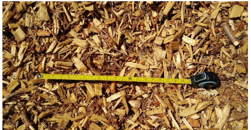
Figura 3. Tipologia di cippato ottenuto con cippatrice a tamburo – alta percentuale di pezzature fini/polvere
