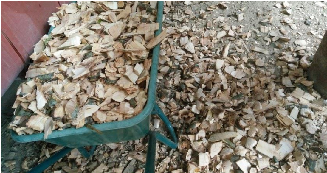
Figura 2. Pezzi esclusi dalla selezione del vaglio dopo cippatrice a vite
