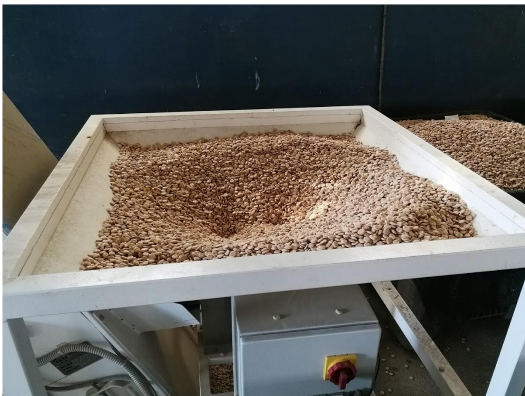
Figura 23. Selezione con lettore ottico e verifica a mano dell'idoneità del materiale
