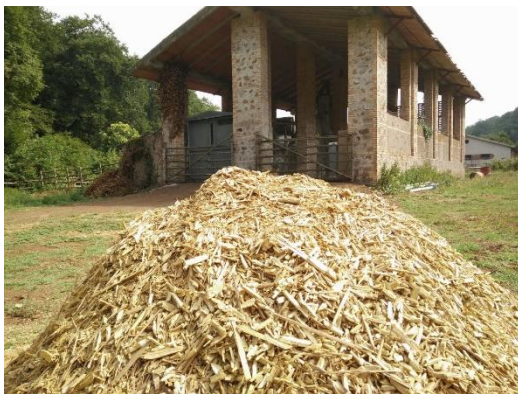
Figura 3. Tipologia di cippato ottenuto con cippatrice a tamburo – alta percentuale di pezzature fini/polvere
