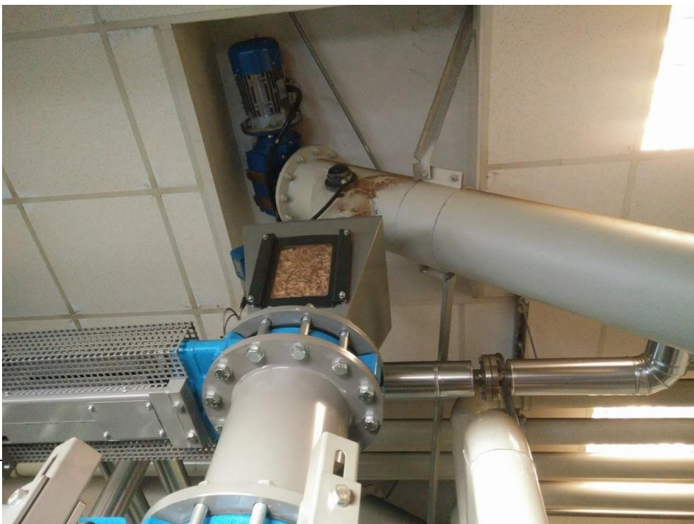
Figura 5. Sistema di vagliatura Vibrowest (impianto Mion&Mosole) con tre piani
