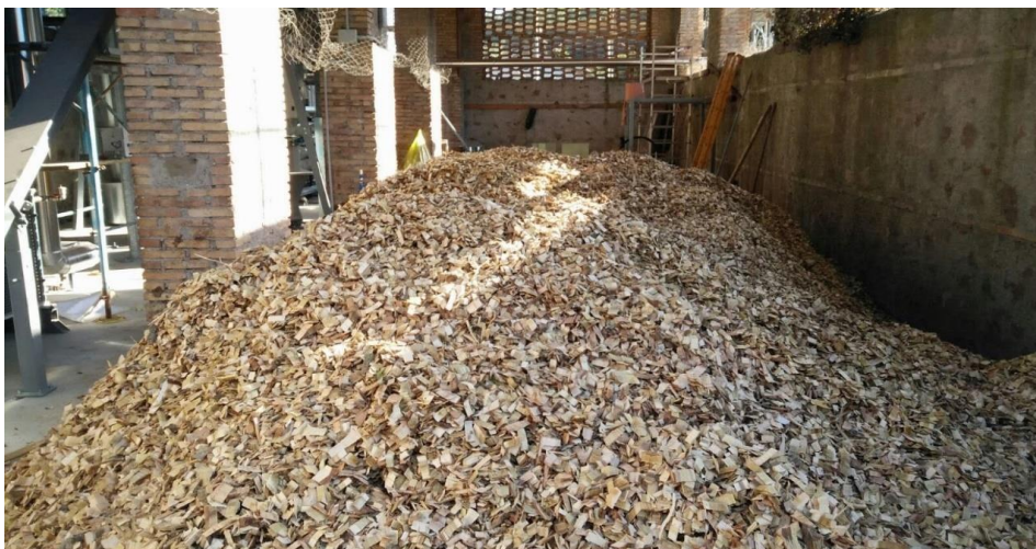
Figura 4. Esempio di pezzatura ottimale ottenuta da cippatrice a vite e vagliatura
